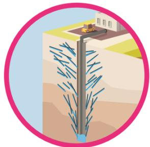
Profondeur de captage : entre 100 et 150 m • Débit : de 50 m<sup>3</sup>/h environ, celui de Soulvache produit jusqu'à 350 m<sup>3</sup>/h du fait de sa morphologie (anciennes galeries de mines de fer ennoyées). **Préconisation : nappes de socle.**
